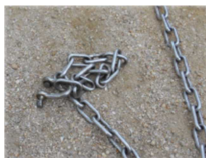
吊り金具破損状況
