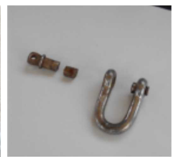
吊り金具破損部詳細
